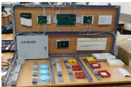
Рисунок 1 – Стенд по автоматизированным системам пожаротушения
