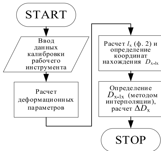
Рисунок 2 – Алгоритм определения обжатия по диаметру вдоль конуса деформации за цикл пильгерной прокатки
